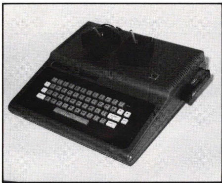
Afb. 3. In een gleuf aan de zijkant kunnen de programmamodulen worden geschoven.
